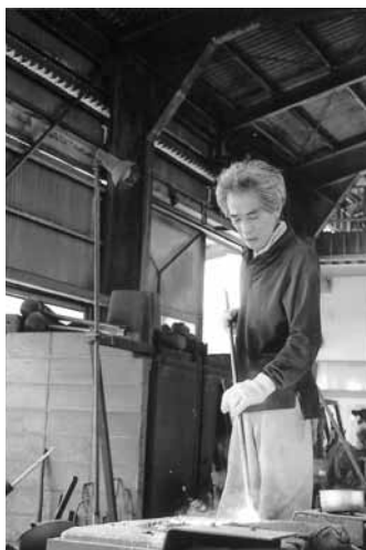
冷却した製品はバリと呼ばれる余分な部分が削り取られる 丹念に続く仕上げ作業。和鉄ポットの完
