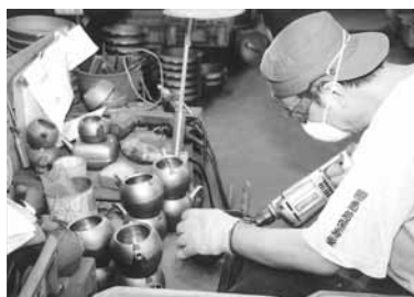
冷却した製品はバリと呼ばれる余分な部分が削り取られる 丹念に続く仕上げ作業。和鉄ポットの完
