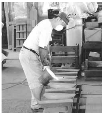
(写真上から)「工房の一角、松田工務長が鑄鉄を溶かす。」「溶けた鉄を砂型に流し込む職人はお湯注ぎと呼ぶ。」「注ぎ口の型枠を外す。いずれも緊張の連続だ。
