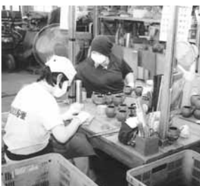
冷却した製品はバリと呼ばれる余分な部分が削り取られる 丹念に続く仕上げ作業。和鉄ポットの完
